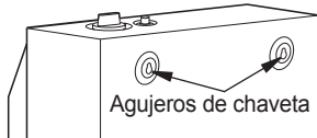
Figura 9 - Ubicación de los agujeros de chaveta en el panel posterior del calentador
