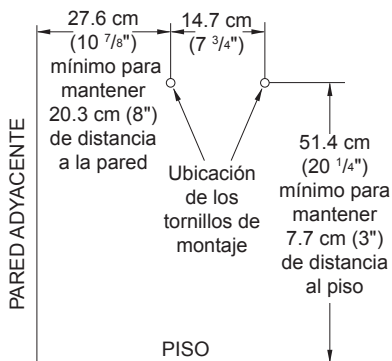
Figura 5 - Ubicación de los tornillos de montaje
