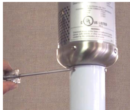
Figura 6 - Fijación del ensamblaje de control y quemador al poste
